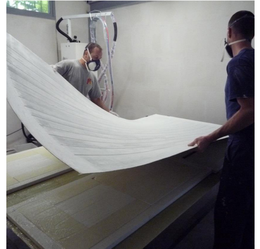
Encollage et pose de la deuxième peau
